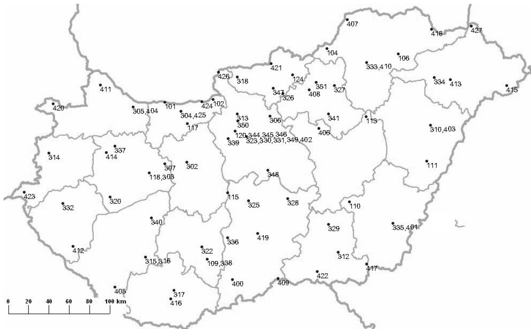
1.1.1. ábra. A dózisteljesítmény-mérőhelyek országos elhelyezkedése (a 100-as kezdetű kódok az OKF, a 300-as kezdetűek a HM, a 400-as kezdetűek az OMSZ mérőhelyeit jelölik)
